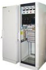
Шкаф оперативного тока серии ШОПТ предназначен для приема электрической энергии собственных нужд переменного тока от двух независимых источников переменного тока (секций собственных нужд) и преобразования ее в электрическую энергию постоянного тока. Шкаф ШОПТ используется для распределения электрической энергии постоянного тока по цепям собственных нужд.
