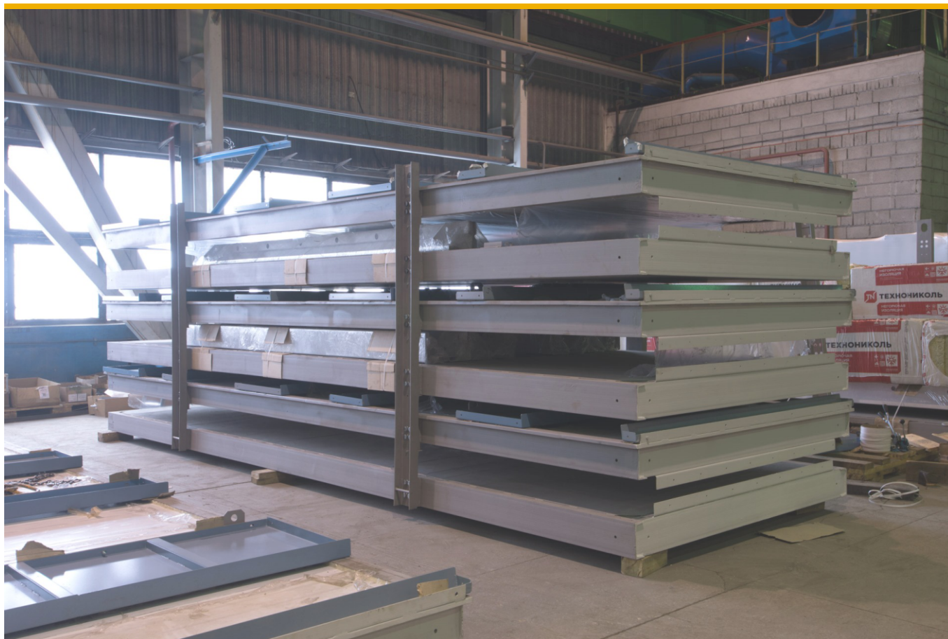
Рис.3.3 Транспортный пакет из трёх блок-модулей
