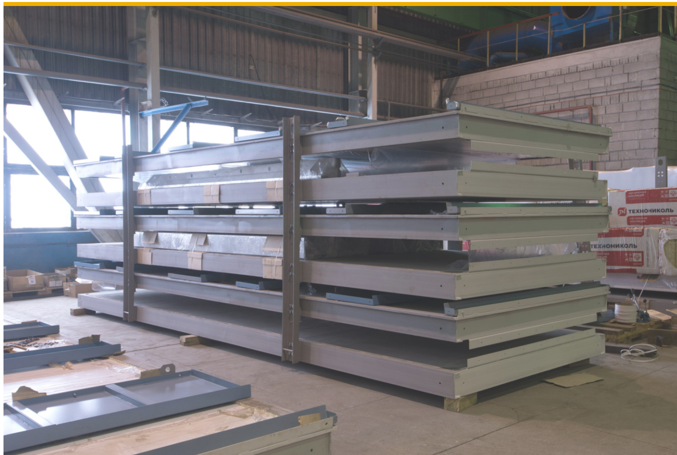
Рис.3.4 Для снижения транспортных затрат блок-модули можно транспортировать в разобранном виде. В один седельный тягач с полуприцепом (фура), входит до 8 блоков.
