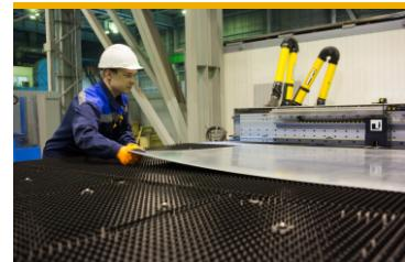
2. Раскрой заготовок выполнен с применением высокоточного координатно-пробивного пресса.
