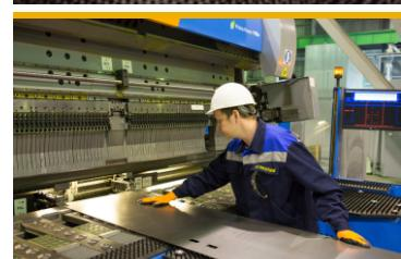
3. Гибка заготовки происходит на автоматизированном комплексе с применением устройства считывания штрих-кода для автоматической установки и пуска новой программы.
