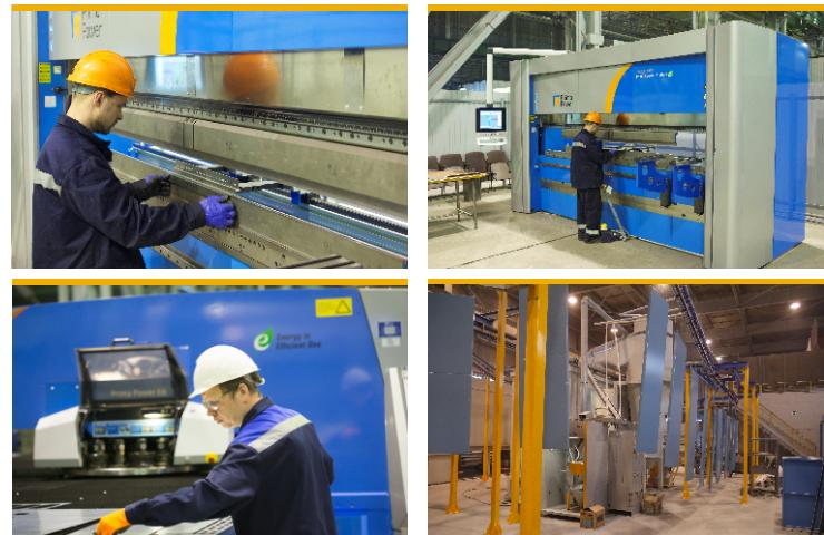
3. Автоматизированный комплекс (включающий устройство считывания штрих-кода для автоматической установки и пуска новой программы) ведет гибку заготовки.
