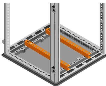
**Назначение:** монтаж тяжелого оборудования.
