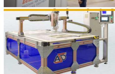
7. Применение дозирующего робота для нанесения полиуретанового уплотнения позволяет достичь высокой степени пыли- и влагозащиты.
