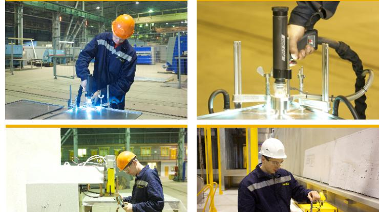
4. Сварка стыков корпуса осуществляется непрерывным циклом для придания жесткости и плотности изделию. Это возможно благодаря высокой точности в производстве заготовки.
