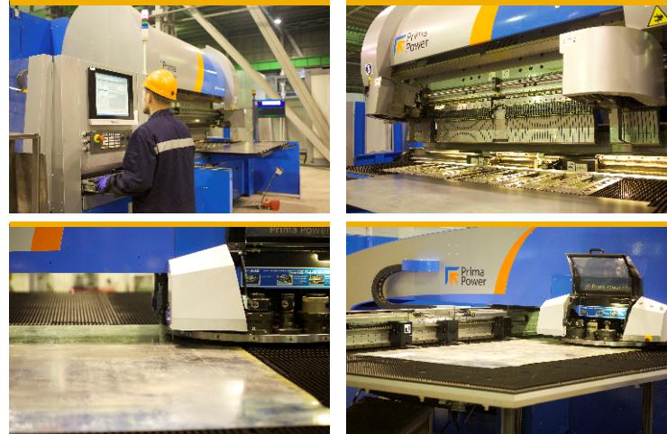
2. Раскрой корпуса выполняется на одном листе стали с использованием высокоточного координатно-пробивного пресса.
