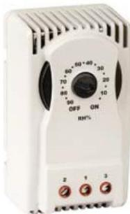
**Назначение:** Включение обогревателя или вентилятора при превышении жестко установленной относительной влажности в шкафу, таким образом не допускается достижение точки росы и предотвращается образование конденсата на оборудовании или электронных компонентах.
