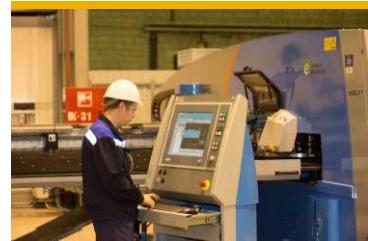
2. Раскрой заготовок выполнен с применением высокоточного координатно-пробивного пресса.
