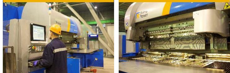
2. Раскрой корпуса выполняется на одном листе стали с использованием высокоточного координатно-пробивного пресса.
