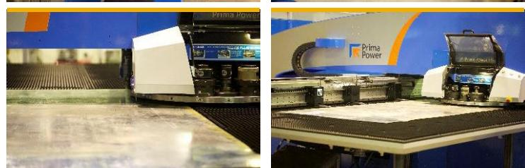
3. Автоматизированный комплекс (включающий устройство считывания штрих-кода для автоматической установки и пуска новой программы) ведет гибку заготовки.
